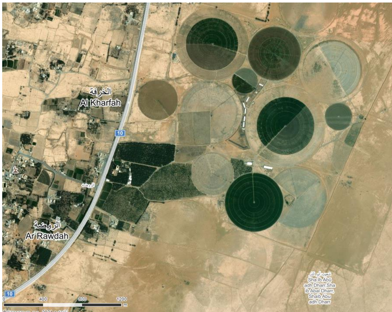
Obr. 18. Čerpání vody z hlubokých studní pro kruhové závlahové systémy vede k destrukci starobylých kanátů (okolí města Layla, centrální část Arabského poloostrova).
